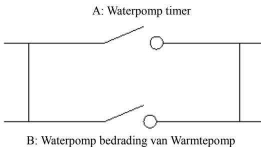
**Opmerking:** De installateur moet A parallel met B verbinden (zoals op de tekening hierboven). Om de waterpomp te starten: A of B is verbonden. Om de waterpomp te stoppen zijn A en B allebei ontbonden.
