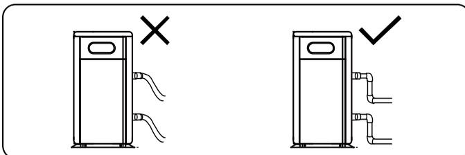
2) Met het oog op een efficiënte verwarming moet de lengte van de waterleiding tussen het zwembad en de warmtepomp ≤ 10m zijn.
