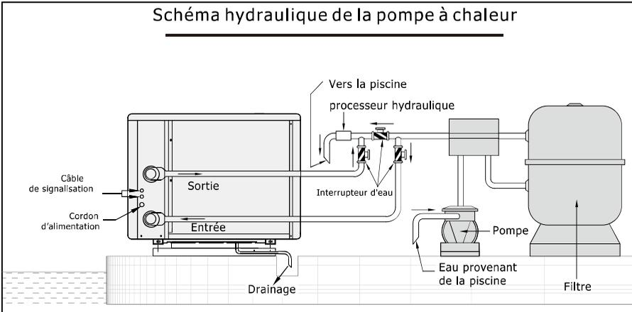
(Remarque: Ce schéma est juste un support de référence et le circuit hydraulique représenté est simplement une base)
