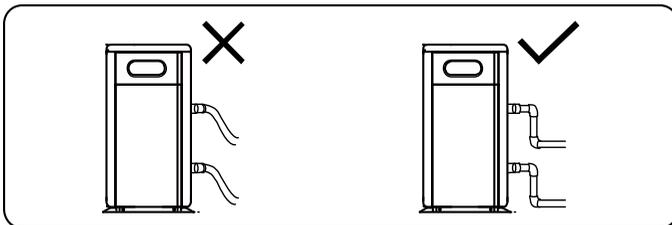
2) Um die Heizfähigkeit gewährleisten zu können, sollte die Länge der Wasserleitung ≤10m zwischen dem Pool und der Wärmepumpe sein.
